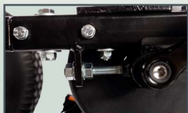
Kettenspanner mit sehr einfacher Bedienung
